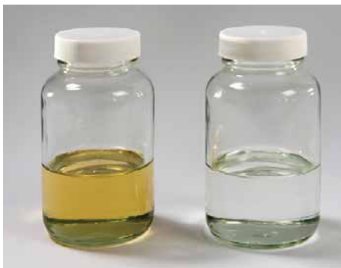
Vergeleken met gewone diesel is Shell GTL Fuel (rechts) helemaal helder. Dit komt doordat er geen aromaten in de brandstof zitten.
